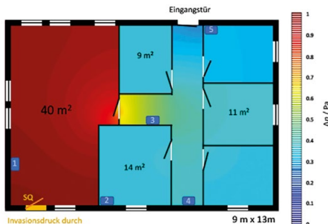
Abb. 2: Berechnete räumliche Verteilung der Druckerhöhung \Delta p in einer Wohnung zum Zeitpunkt 0,18 s nach dem Öffnen des Fensters SQ. Die Berechnung verdeutlicht, dass die kurzzeitige Druckerhöhung ( \Delta p > 0 ), verursacht durch das Öffnen des Fensters, sich auf alle Räume ausbreitet.
